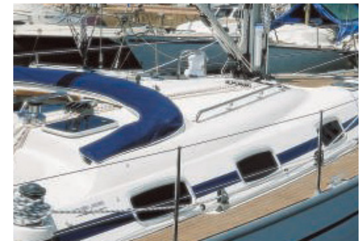
Alles Serie: Instrumente im Tisch, elektrische Ankerwinch und Achtertagsspanner. Die Teleskop-Badeleiter verschwindet unter einer Klappe
