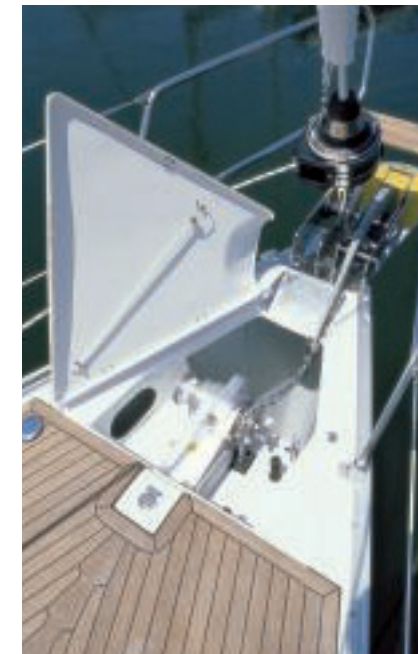
Alles Serie: Instrumente im Tisch, elektrische Ankerwinch und Achtertagsspanner. Die Teleskop-Badeleiter verschwindet unter einer Klappe
