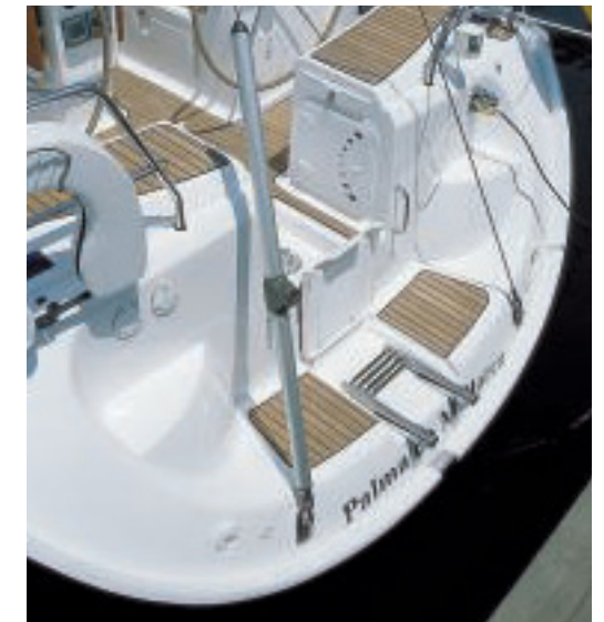
Alles Serie: Instrumente im Tisch, elektrische Ankerwinch und Achtertagsspanner. Die Teleskop-Badeleiter verschwindet unter einer Klappe
