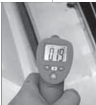
HET CONTROLEREN VAN DE TEMPERatuur TIJDENS HET HARDINGS-PROCES IS ESSENTIEEL VOOR EEN GOED RESULTAAT.
