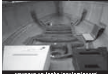
wrangen en tanks ingelamineerd
