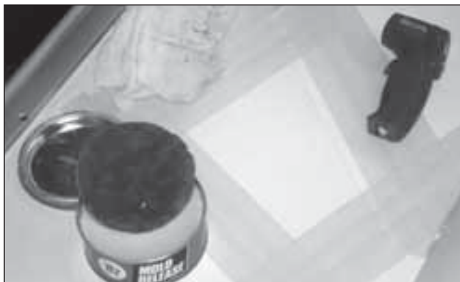
OP EEN ONBESCHADIGD DEEL VAN HET DEK WORDT DE BENODIGDE VORM AFGEPLAKT...
