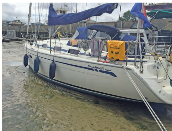
Het eerste jaar zakte het waterpeil in de haven nog zo ver dat boten op sommige plekken in de haven in de modder zakten. Inmiddels zijn de sluisdeuren aangepast, waardoor het water niet meer zo ver zakt
