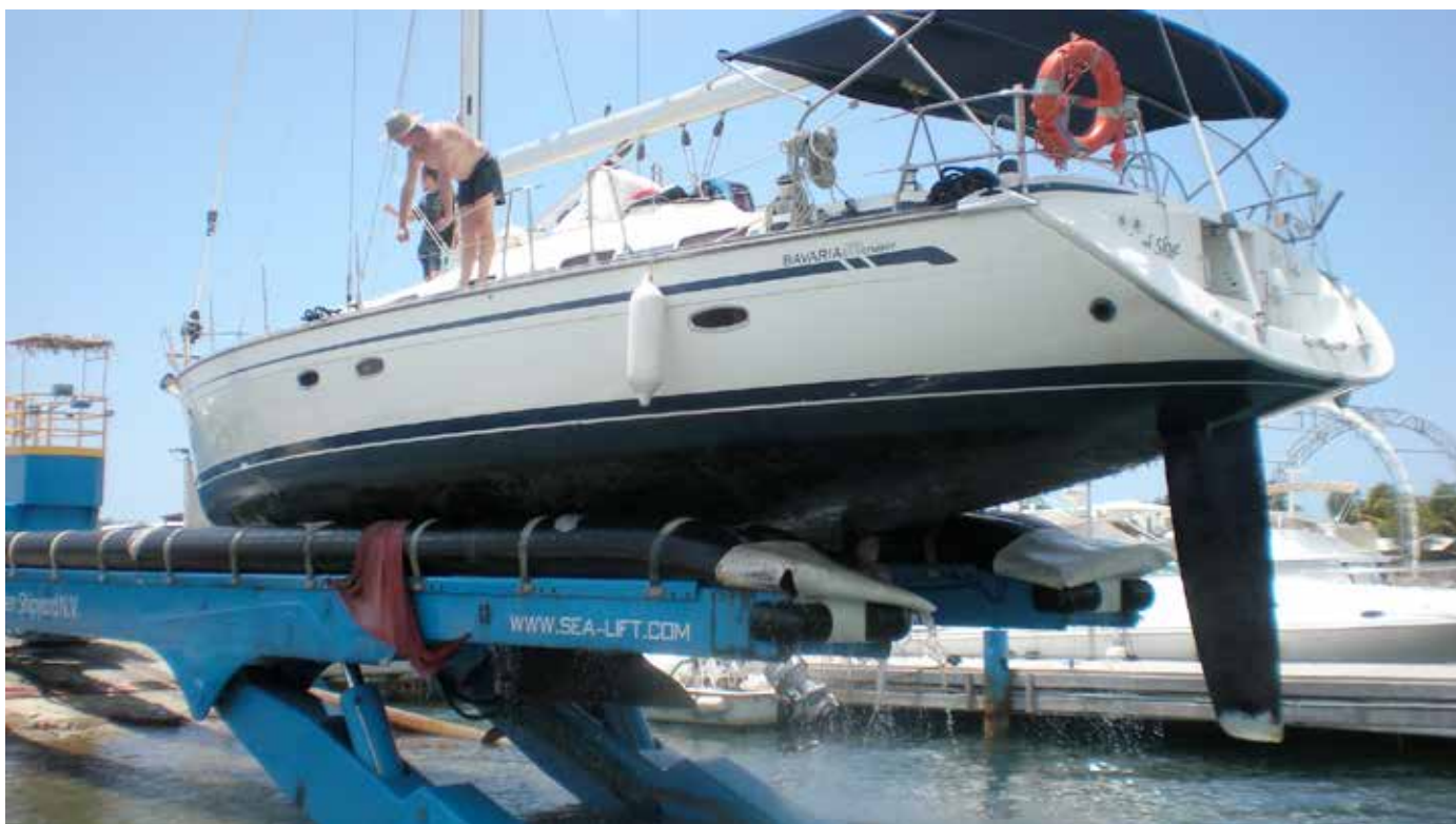
De boot op St Maarten het water uit om onderwaterschip te inspecteren, schoonmaken en een nieuwe schroef te monteren.
