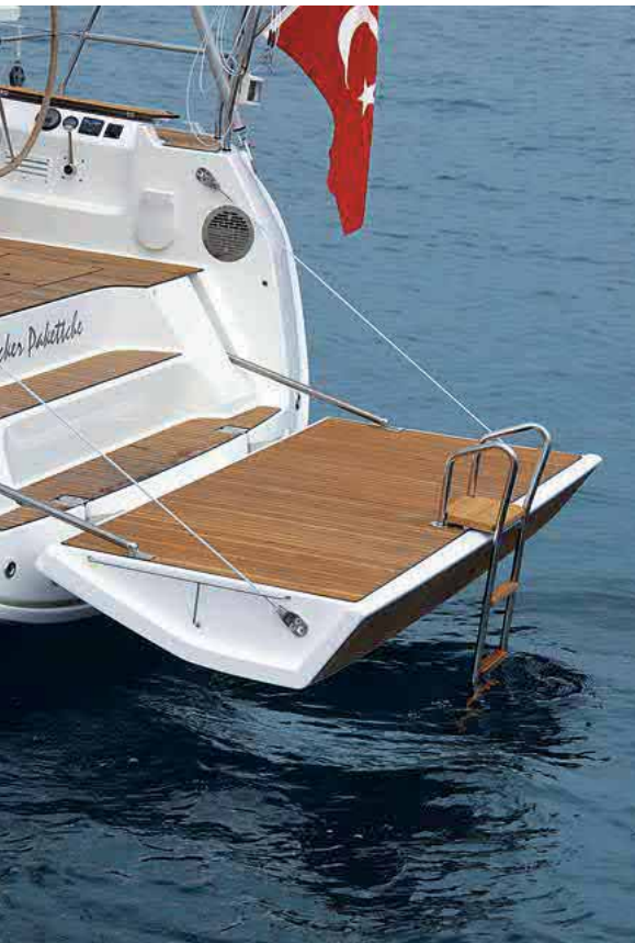
Badeinsel. Die Leiter lässt sich auch am Bug oder an der Seite einhängen
