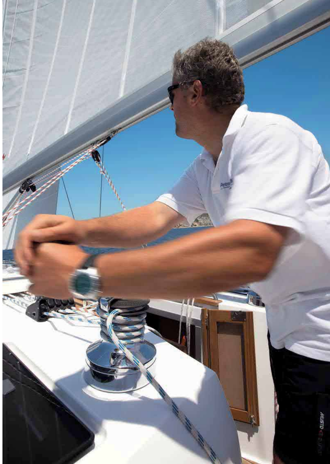
Großschot im Einsatz. Zwei unabhängige Taljen ersetzen den Traveller
