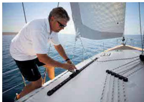
Schienen auf dem Dach. Leider erfolgt die HOLEPUNKTVERSTELLUNG per Bolzen
