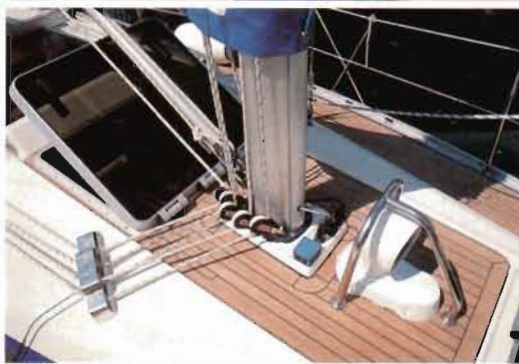
Großdimensionierte Lüftungshutze Generously sized dorade-vent
